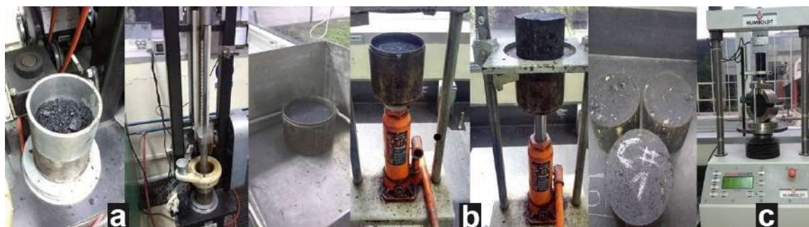
Figura 2. Elaboración y ensayo de briquetas de mezclas asfálticas en caliente utilizando asfalto modificado con aditivos no convencionales. a) Compactación b) Enfriamiento y extracción de briquetas c) Ensayo Marshall
