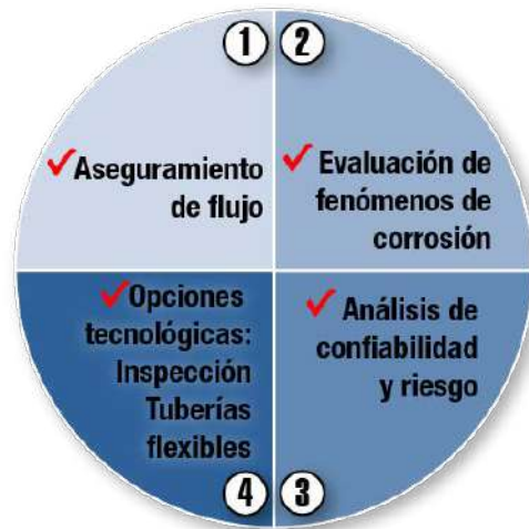
Figura 1. Secuencia de análisis general aplicado en la metodología de integridad de tuberías considerando el proceso de degradación por corrosión interna
