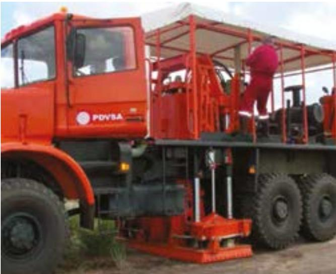
Método de adquisición sísmica.
